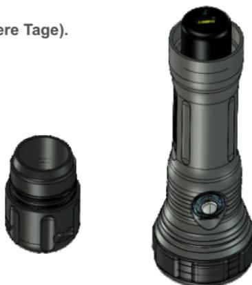
Beim erneuten Anbringen das Gehäuse, die O-Ringe überprüfen, reinigen und leicht mit Silikonfett einschmieren.
